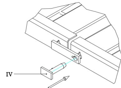
Nächstes Element mittels Hebezeug ausrichten und Verriegelungsbolzen durch die Lasche und dann in das Baustraßenelement einstecken. Element erst dann endgültig ablegen
