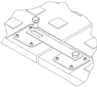
Die Panels werden mittels Metallverbinder und Sechskantschraube miteinander verbunden. Zunächst wird der Metallverbinder im kreisrunden Loch durch eine Schraube mit dem Panel verbunden. Anschließend wird die Schraube im Langloch montiert.
