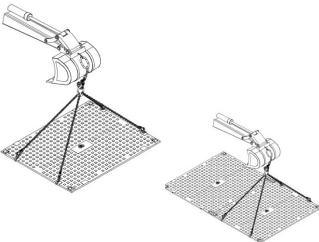
Das Baustellenpanel kann jetzt positioniert werden. Dazu ist es möglichst bodennah, in waagerechter Position zu bewegen. Es ist darauf zu achten, dass sich keine Personen im Gefahren- bzw. Schwenkbereich befinden.
