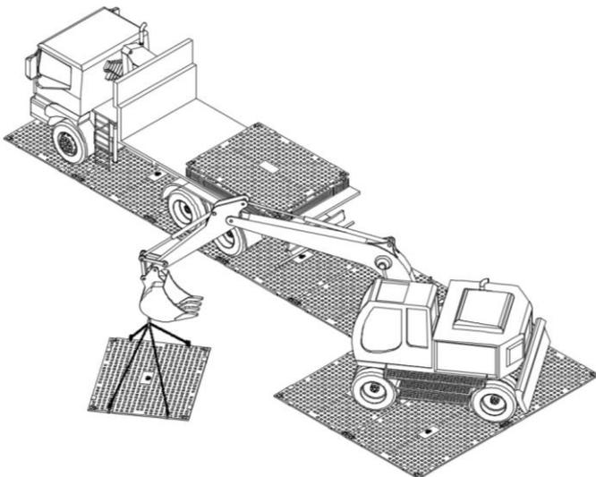
Die Baustraßenpanels können fortlaufend verlegt und nach Befestigung befahren werden. Ein Befahren mit Kettenfahrzeugen ist nur mit Gummikette erlaubt und setzt eine vorherige Einweisung voraus.
