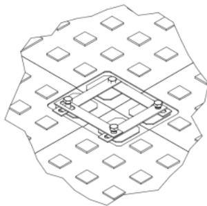
Bei einer Flächenverlegung der Panels erfolgt die Befestigung der Panels untereinander reihum.
